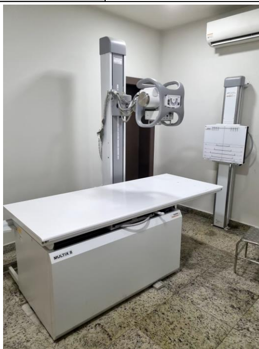
Foto do equipamento de raios X fixo.
