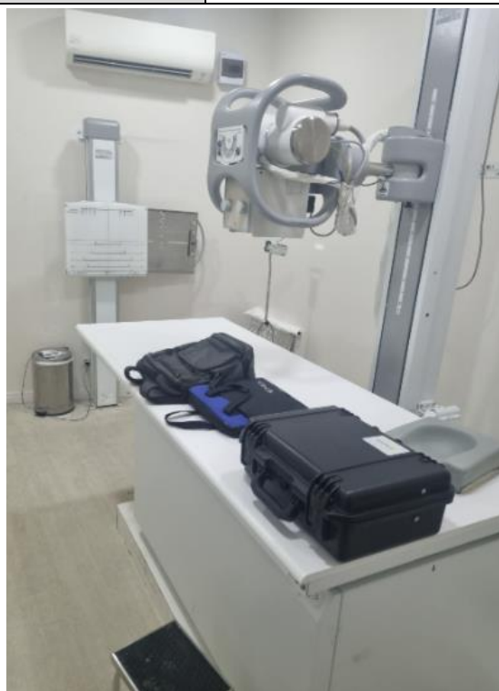
Foto do equipamento de raios X fixo.
